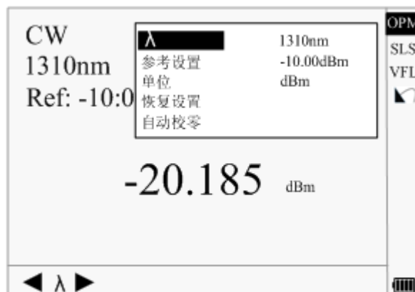
图 4-13. 光功率计测试参数设置
