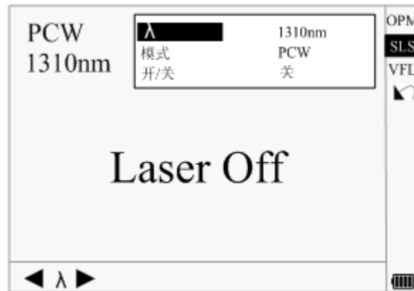
图 4-15. 稳定光源测试参数设置
