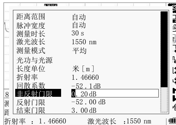
图 3-19. 非反射门限设定
